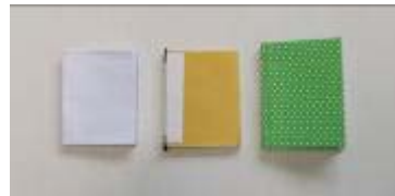
(手のひらサイズの洋本) (左) 本文用紙を糸綴じしたもの (中央) 背を補強したもの (右) 表紙を付けたもの
